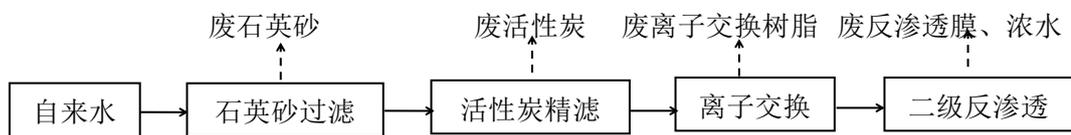
图 2-2 纯水制备工艺流程及产污环节图
