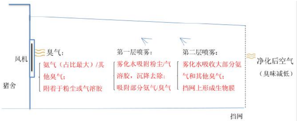
图 7.2-2 风机后端除臭挡网装置的技术原理
