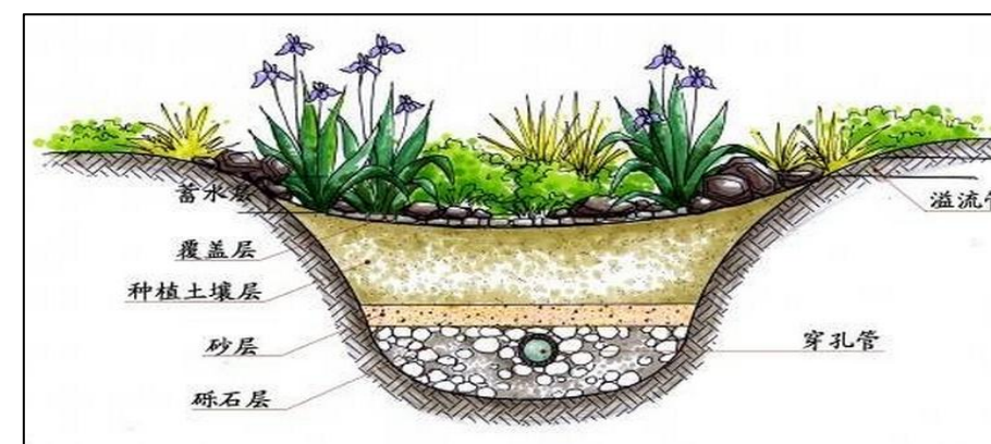
植草明沟+暗渠组合净化系统示意图
